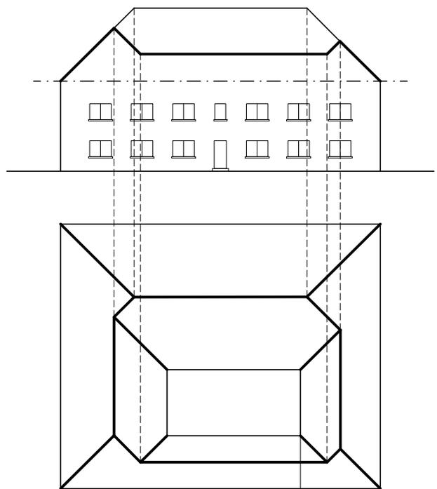
1. Completar la planta y el alzado de la cubierta determinando las intersecciones de los planos que la constituyen.
