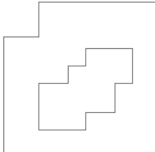
1. Completar la planta y el alzado de la cubierta determinando las intersecciones de los planos que la constituyen. Todas las vertientes forman ángulos de  $45^\circ$  con el plano horizontal.
