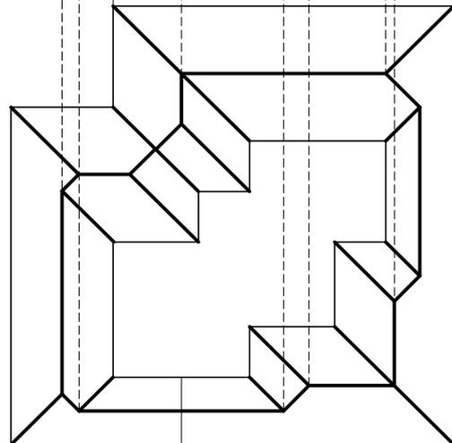
1. Completar la planta y el alzado de la cubierta determinando las intersecciones de los planos que la constituyen.
