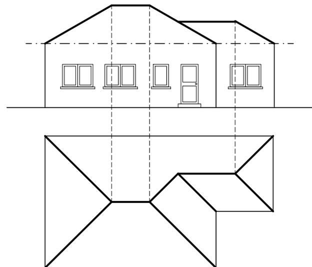
1. Completar la planta y el alzado de la cubierta determinando las intersecciones de los planos que la constituyen.
