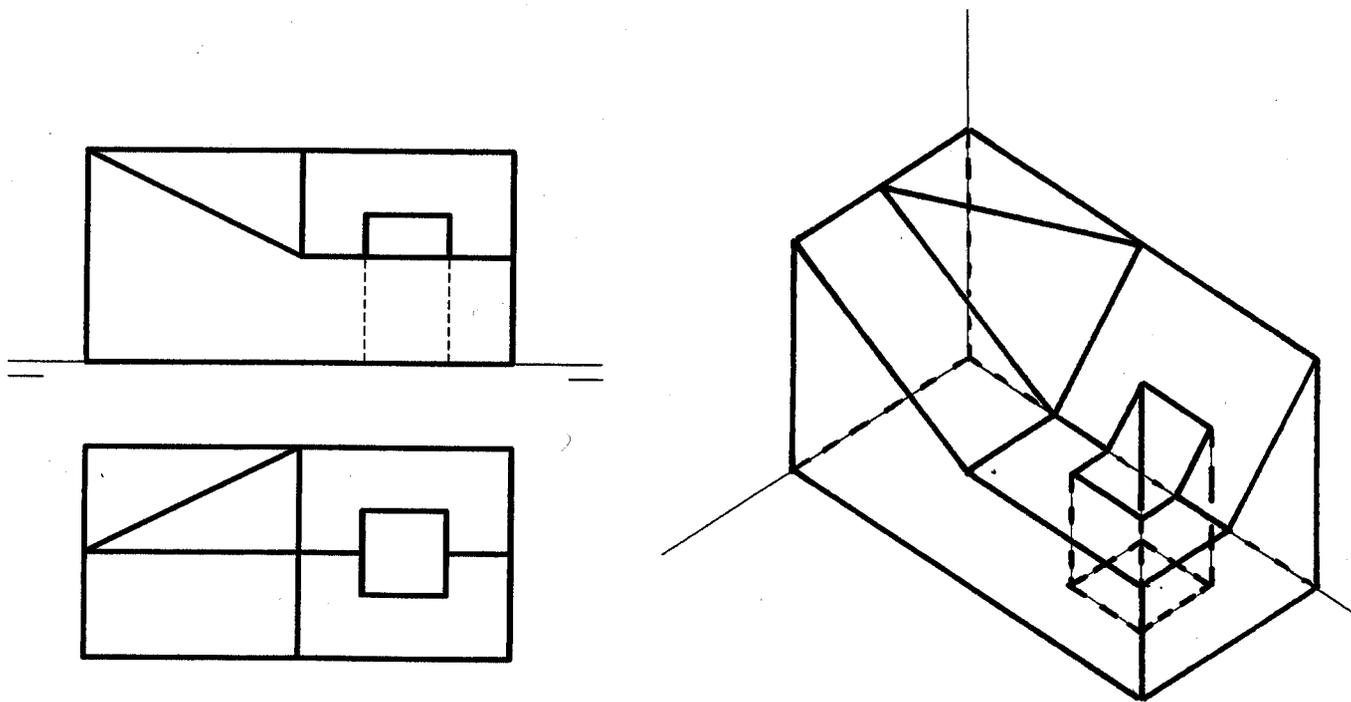
C2.- La pieza 1, representada en *dibujo* isométrico, tiene en su interior un hueco en el que se ajusta la pieza 2. Representar el alzado de la pieza 1 con un corte a 90°. Acotar según normas.
