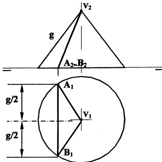
C1.- Dadas la proyecciones de la pieza siguiente, en el sistema diédrico, dibujarla en isométrico (no aplicar reducción).
