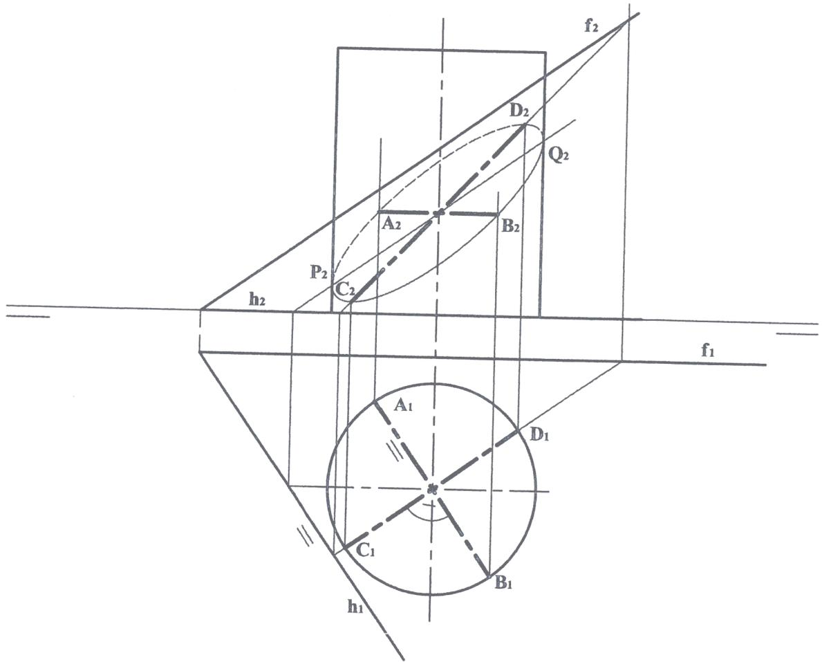
**B3.-** Determinar la nueva posición del cubo, representado en perspectiva lineal en la figura, tras desplazarlo en la traslación definida por la diagonal  $AC$ .
