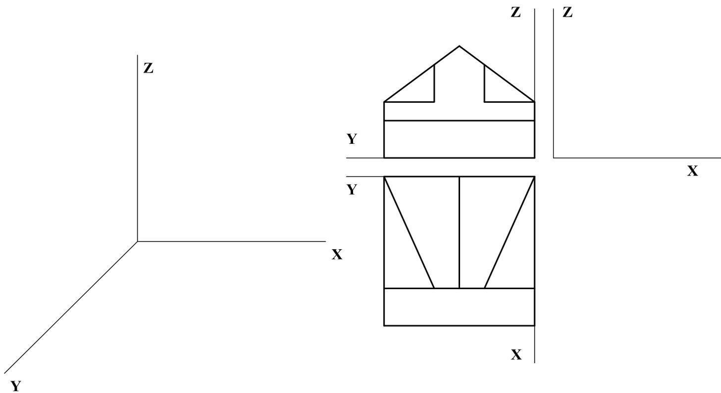
**A4.-** Acotar la pieza representada en la figura para su correcta definición dimensional. El espesor de la pieza es de 10 mm.
